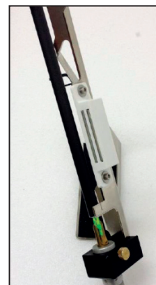
1. Inserire l'asta sull'impennatore assicurandosi che sia ben inserita sull'adattatore per la cocca.
