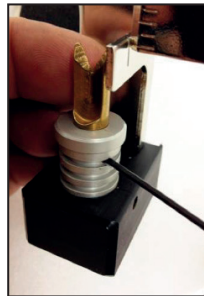
4. Nockaufnahme um 90° drehen und an der eingravierten Markierung ausrichten und nun die Stellschraube wieder fixieren, nun ist das Tool auf Compound Setup umgestellt.
