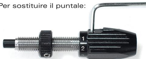
Portare la regolazione della potenza al minimo, togliere il grano di bloccaggio o la farfallina dalla sua sede con la chiavetta. Guardando attraverso il foro girare fino a raggiungere un secondo foro sul pistoncino centrale. Inserire la spinetta per bloccare il movimento di rotazione e svitare il puntale. Ripetere l'operazione al contrario per il montaggio.
